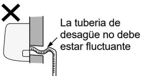
La tubería de desagüe no debe estar fluctuante
