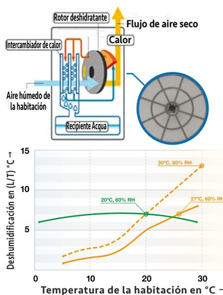
Muy silenciosos. Los deshumidificadores desecantes garantizan una alta deshumidificación en el ambiente en el que se utilizan, incluso en bajas temperaturas.
